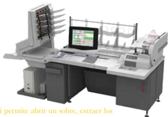
La AS3690i permite abrir un sobre, extraer los contenidos, identificarlos, escanearlos, orientarlos, ordenarlos e imprimir información en tan sólo un paso. Este modelo dispone de un escáner de alta velocidad con un alimentador especial "drop feed", integrado con una abridora automática de cartas. Mediante la combinación de extracción de correo con su posterior digitalización, ya no es necesario enviar papel fuera de la sala de correspondencia para ser procesado.
